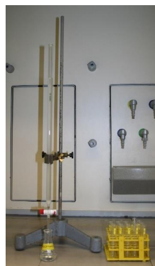
Slika 38. Tijek kromatografije na stupcu prilikom odjeljivanja dvokomponentne smjese obojenih spojeva. Vidljivo je širenje vrpce tijekom odjeljivanja. Što se tvar dulje zadržava na koloni (manji R_f , prikazano plavo) vrpca će biti šira i komponenta će se eluirati u većem broju frakcija. Desno – tipični postav za provođenje kromatografije na stupcu
