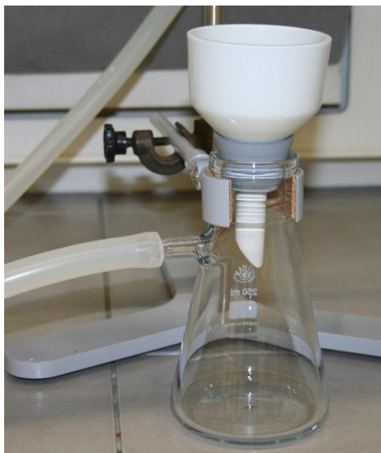
Slika 28. Postav za filtraciju keramičkim Büchnerovim lijevkom
