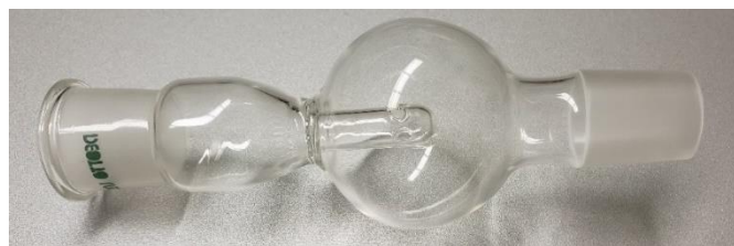
Slika 25. Posebni nastavak koji sprječava prskanje tekućine u hladilo pri uparavanju na rotacijskom uparivaču
