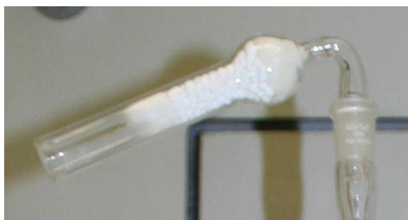
Slika 17. Klor-kalcijeva cjevčica ispunjena granulama kalcijevog klorida
