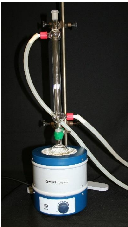
Slika 16. a) Aparatura sa zagrijavanjem pomoću grijaće kape; b) grijaća kapa
