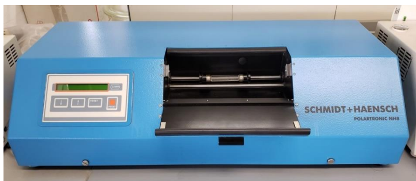
Slika 60. Polarimetar i različite izvedbe ćelija za mjerenje optičkog skretanja
