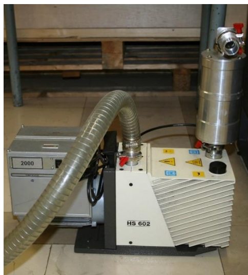
Slika 44. Neke izvedbe vakuumpumpi: a) membranska pumpa; b) mehanička uljna pumpa
