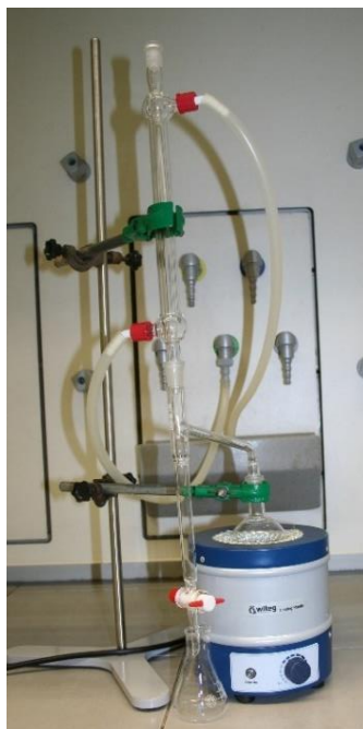
Slika 48. Aparatura za azeotropnu destilaciju vode s Dean-Starkovim nastavkom
