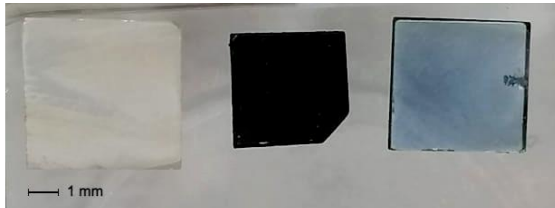
Nedopirani STO za usporedbu te STO-Nb i STO-OVD korišteni u mjerenjima.
