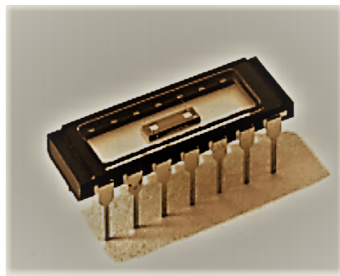
Slika 1. Detektorska dioda SiTek S-0341 (1L2.5UV_CP2_NW).[2]
