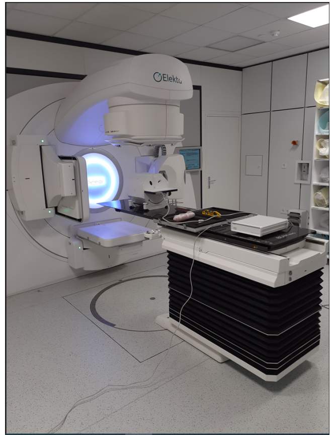
Slika 3. Eksperimentalni postav za predaju i mjerenje radioterapijskim planovima propisanih raspodjela doze smješten u sobi za provedbu radioterapije. Na slici se mogu vidjeti glavne komponente postava koje uključuju Elekta Agility linearni akcelerator i PTW Octavius II fantom s umetnutim PTW Octavius Detektor 1500.
