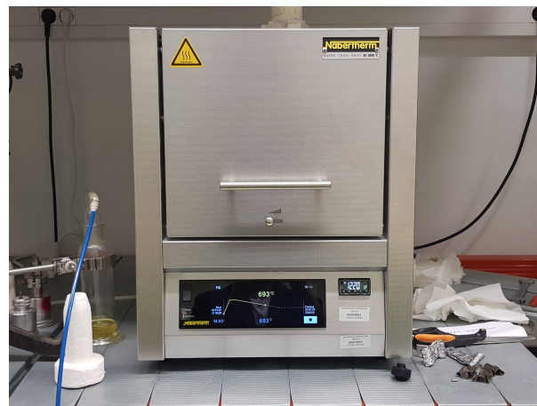
Slika 7: Slika mufolne peći za rast kristala. Peć je elektronički upravljana s finom regulacijom temperature te može doseći temperaturu do 1200^{\circ}\text{C} .
