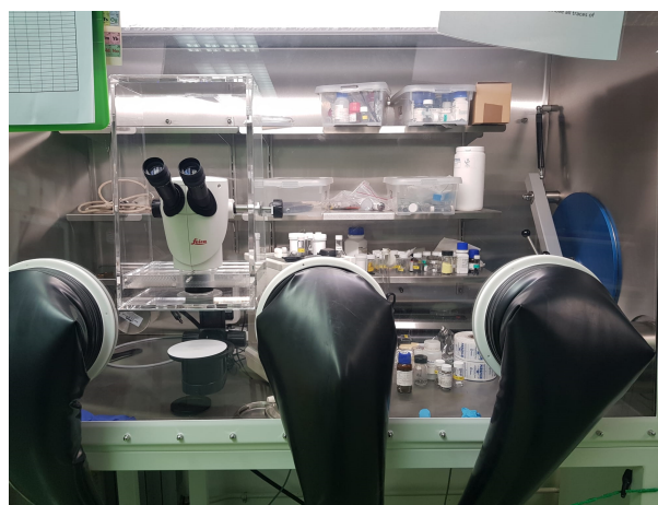
Slika 5: Komora s inertnim plinom (Argonska komora). Komora služi za manipulaciju materijalima (kemijskim elementima) koji su osjetljivi na kisik, CO 2 ili vodu. Koncentracija vodene pare i kisika u komori je ispod 0.1 ppm.
