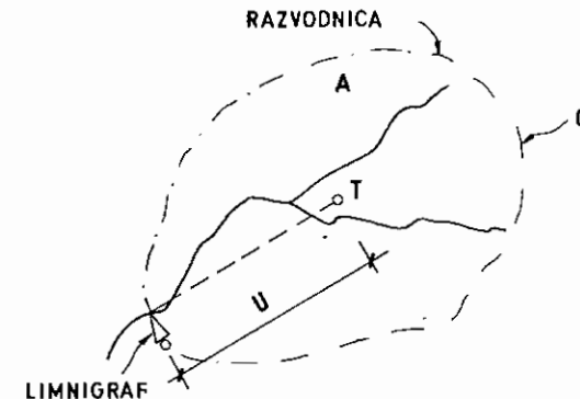
Slika 4.20 Skica sliva s osnovnim elementima za definiranje koeficijenta koncentriranosti
