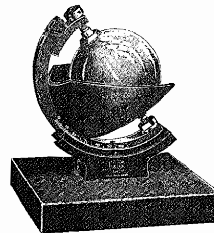
Slika 3.12 Campbell-Stokesov heliograf (Meteorological Instruments, Casella, 1963.)
