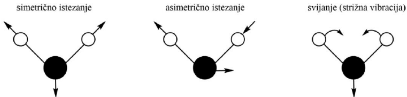
Vibracije istezanja i savijanja veza
