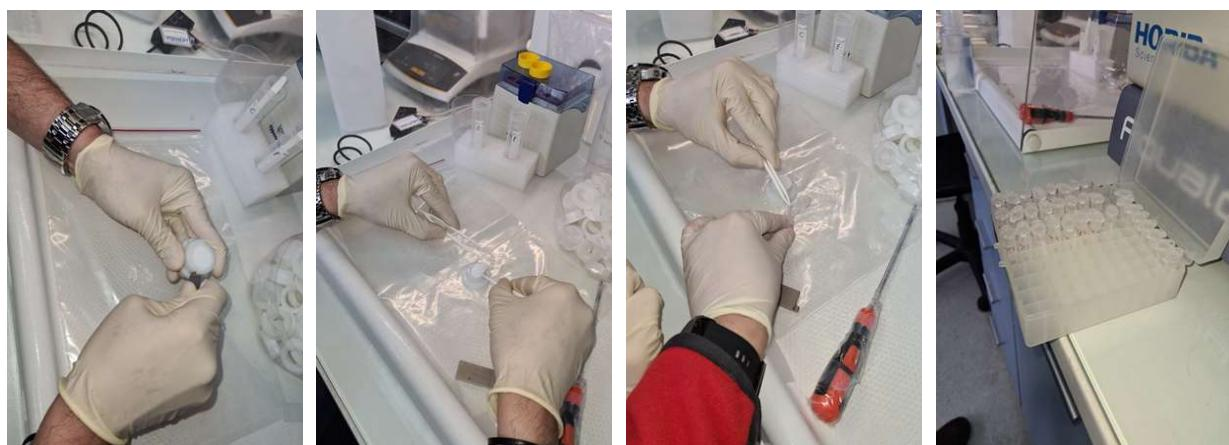
Slika 13. Razdvajanje poklopca i klipa, odvajanje membrane i gelova, otapanje vežućeg gela iz uzorkivača DGT
