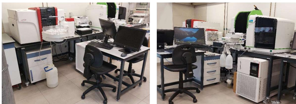
Slika 18. FAAS NovAA 800F (Analytik Jena) i ETAAS PinAAcle 900Z (Perkin Elmer)
