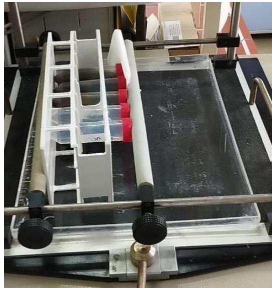
Slika 14. Ekstrakcija uzorka sedimenta (prvi korak procedure BCR)
