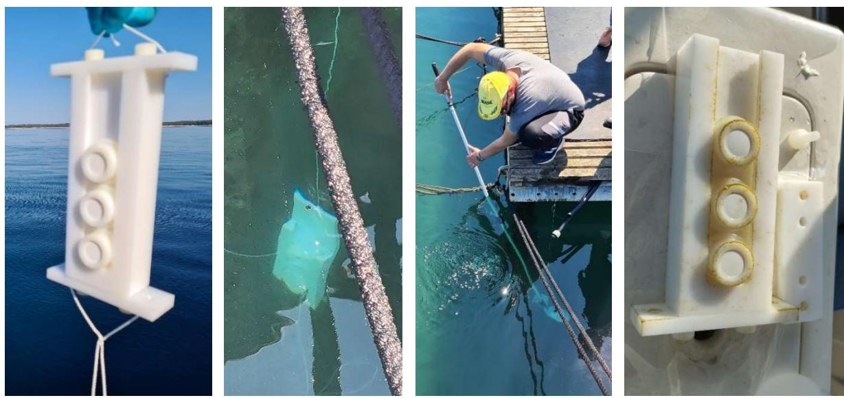
Slika 12. Uzorkivači na držaču prije izlaganja, uzorkivač DGT tijekom izlaganja u morskoj vodi, uzimanje dnevnih uzoraka vode i uzorkivači nakon kraja vremena izlaganja
