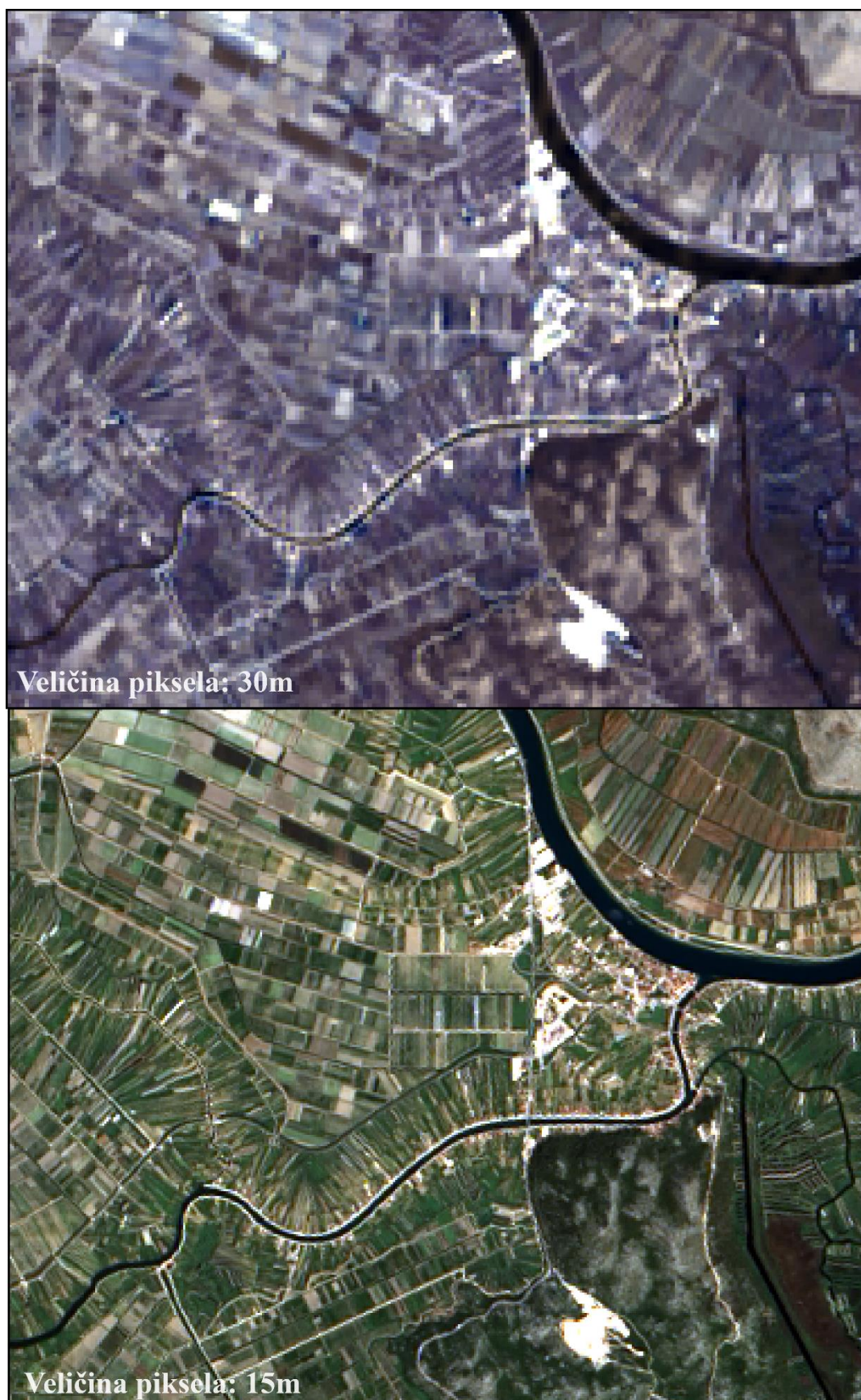
Sl. 8. Kompozitna snimka prije i poslije izoštravanja – Landsat 8 OLI TIRS (Opuzen)
