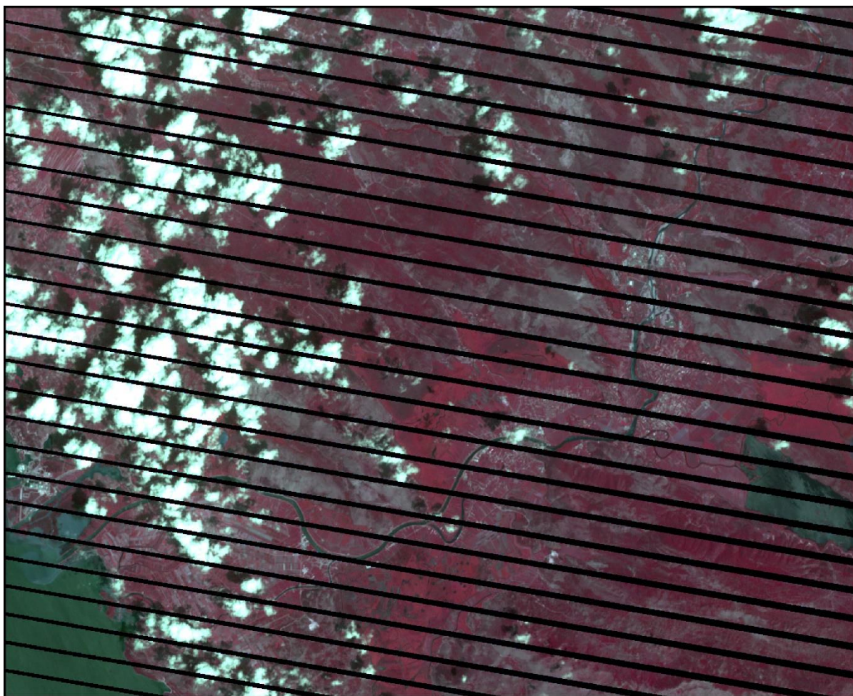
Sl. 9. Periodične pruge nastale zbog kvara na Scan Line Correctoru (SLC) (Landsat 7 ETM+)
