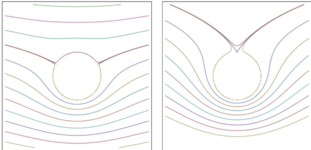
Zavisno od jačine vrloga, na površini cilindra mogu biti dvije asimetrične točke stagnacije ili samo jedna ili čak niti jedna. Točka stagnacije (mrvila, zastoja) je ona u kojoj je brzina tekućine po iznosu jednak nuli.
