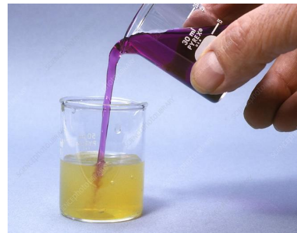
Slika 2. Redukcija \text{KMnO}_4(\text{aq}) s \text{FeCl}_2(\text{aq}) . 2
