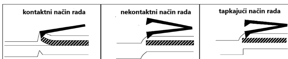
Slika 13. Načini rada AFM-a. Preuzeto i dorađeno iz reference 16.
