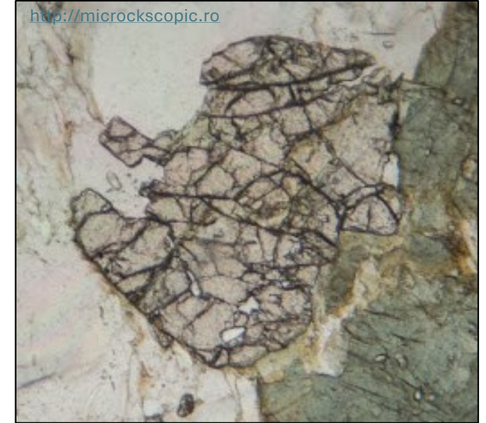
pukotine u granatu
