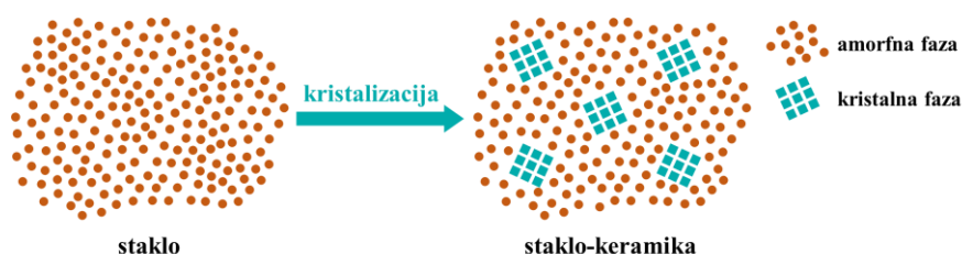
Slika 6. Shematski dvodimenzijski prikaz strukture praškastog uzorka stakla i staklo-keramike dobivene kristalizacijom ishodnog stakla.
