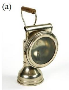
Slika 1.5. Primjer karbidne svjetiljke.*
