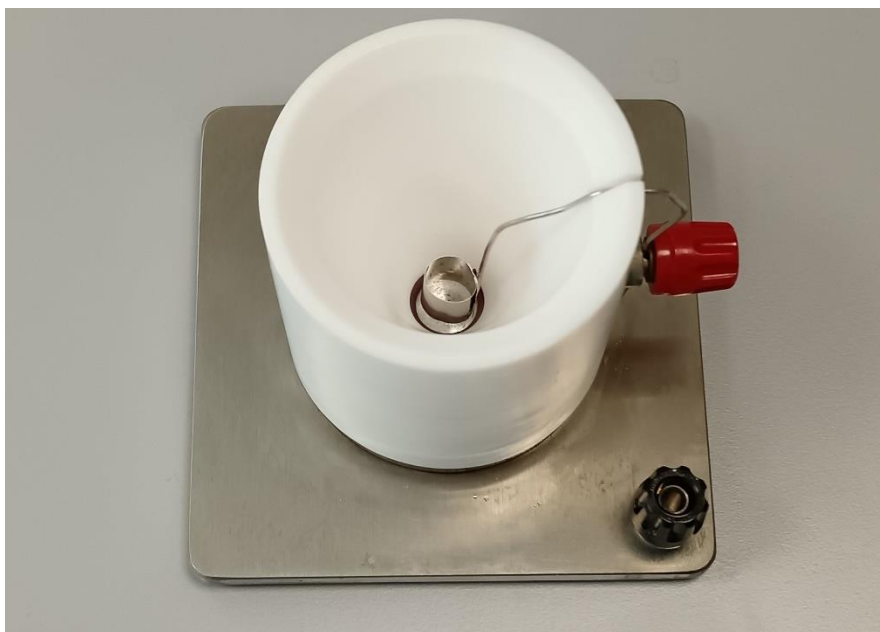
Slika 7. Teflonska elektrodepozicijska ćelija s čeličnim postoljem i cilindričnom platinastom elektrodom.
