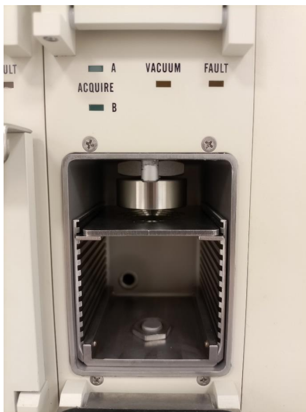
Slika 2. Komorica alfa spektrometra CANBERRA Alpha Analyst™ . Pri vrhu komorice nalazi se PIPSi detektor.
